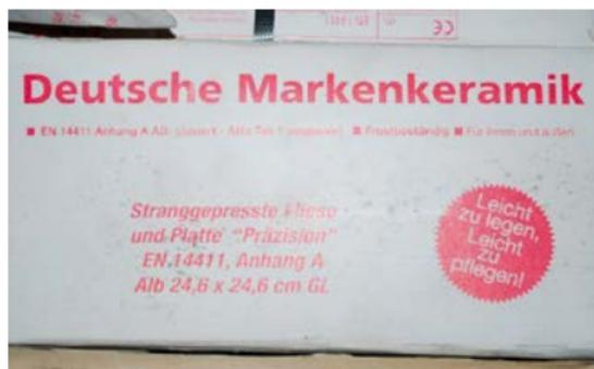
**Abb. 2.3:** Aufdruck auf der Verpackung von stranggepressten Fliesen und Platten: gültige Norm DIN EN 14411, Formgebung A (stranggepresst), Format 24,6 cm × 24,6 cm, Oberfläche glasiert (GL), frostbeständig
